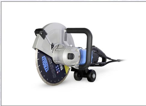
Die TYROLIT HBE ist eine elektrische Handsäge bis zu einer Schnitttiefe von 125 mm, sowohl für Nass- als auch Trockenschnitt. Ein integrierter Staubsaugeranschluss ermöglicht sauberes Arbeiten. Die kompakte Bauweise, das geringe Gewicht sowie demontierbare Führungsrollen erleichtern die Handhabung. Max. Sägeblatt DM 350 mm, Blattaufnahme 25,4 mm, Gewicht 7,9 kg.
