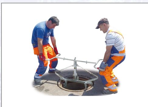
Spezielle Zange zum sicheren und gesundheitsschonenden Greifen und Versetzen von Schachtrahmen und Auflagerringen. Leicht, effizient und wirtschaftlich. Innen greifend, mit abnehmbaren Handgriffen, galvanisch verzinkt. Ideal für Reparaturarbeiten und Einbau auf exaktem Niveau. Mit Wechselautomatik zur vollautomatischen Umschaltung von „voll“ auf „leer“ Mit praktischer Einhängeöse für Hebezeuge. Greifbereich: 20-620 mm, Tragfähigkeit: 150 kg, Gewicht: ca. 20 kg.
