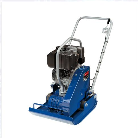
Rüttelplatte vorwärtslaufend mit mechanischer Kupplung und Griffbügel, Bodenplatte aus verschleißfestem Stahlblech und Doppelboden. Technische Daten: Hatz Dieselmotor 1B20, 3,4 kW/4,6 PS, Zentrifugalkraft 25 kN, Arbeitsgeschwindigkeit 22 m/min, Verdichtungstiefe bis ca. 450 mm, Plattengröße BxL=500x620 mm, Gewicht 145 kg.
