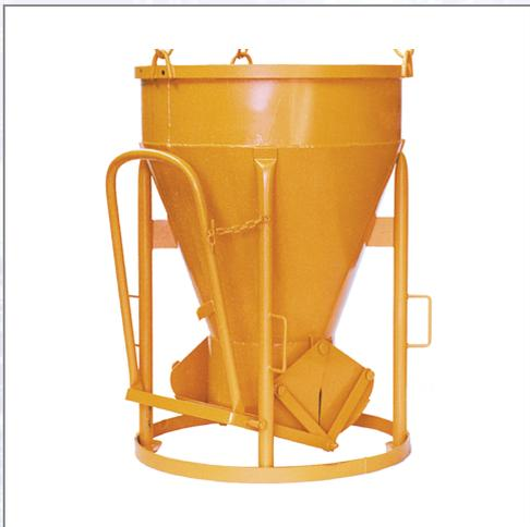
Zylindrische-konische Form mit zylindrischem Auslauf. Extra schwere und stabile Ausführung mit Handhebelbetätigung des Patentverschlusses. Standardmäßig mit angeschweißter Kette, optional mit Haken oder Bügel. Ausführungen mit Hebel oder Handrad. Lieferbar von 150 l bis 4000 l.
