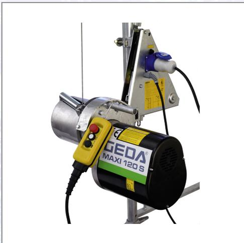
Gerüst-Seilaufzug ohne Schwenkarm mit einer Tragkraft von 120 kg. Steuerung mit Not-Aus 10 m, steckbar. Komplett mit Zugseil, Drallfänger und Haken. - 2 Hubgeschwindigkeiten 20 bzw. 60 m/min, - Motor 0,45 / 1,35 kW / 230 V / 50 Hz.
