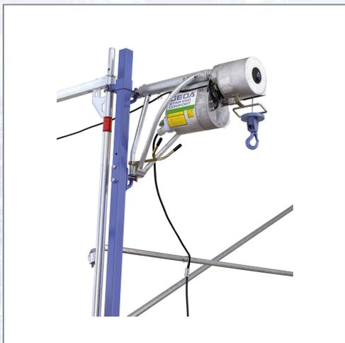
Schwenkarmaufzug mit einer Tragkraft bis 250 kg. Steuerung mit Not-Aus 2 m, steckbar. Teilbar in Elektrowinde 33,5 kg und Schwenkarm 8,5 kg. Mit Zugseil, Drallfänger und Lasthaken. - Hubgeschwindigkeit 28 m/min, - Motor 1 kW / 230 V / 50 Hz.
