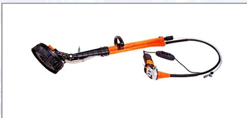
Reinigen von Schalungen, Industrieböden und verschmutzte Oberflächen aller Art. Entfernt mühelos Betonreste auf Schalungen, Schalsegmente können stehend gereinigt werden. Geringer Verschmutzungsgrad durch Trennung von Handstück und Motor. Leichtes Handling durch Teleskopstiel. Technische Daten: - Werkzeug: 480-1670 /min, - Motorleistung: 230 V/1000 W, - Maschinenlänge: eingefahren 105 cm, ausgezogen
