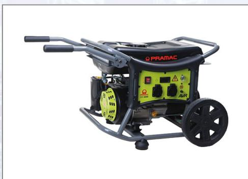
Alle Stromerzeuger der WX-Baureihe sind mit AVR (Automatic Voltage Regulation) ausgestattet. Durch die elektronische Regelung der Stromstärke werden angeschlossene Geräte besser gegen Beschädigungen durch Überspannungen geschützt. Die eingebaute Ölmangelsicherung schaltet den Motor bei zu geringem Ölstand ab. Weiters sind alle WX-Geräte mit einem Multifunktionsdisplay ausgestattet, es können Spannung, Frequenz und Betriebsstunden abgelesen werden.
