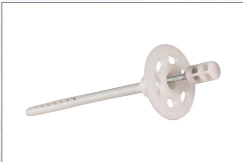
Schlagdübel mit verzinktem Stahlnagel mit Kunststoffkopf für die Montage in Dünnschicht-WDV-Systemen und die Befestigung von Dämmplatten in hinterlüfteten Fassaden (Stein, Aluminium u. a.). Einfache und schnelle Montage, korrosionsbeständig, verbesserte Tragfähigkeit. Verbrauch: ca. 6-9 Stk/m<sup>2</sup>. Geprüft nach ETA 05/148 A, B, C. Keine ÖNORM-Prüfung.
