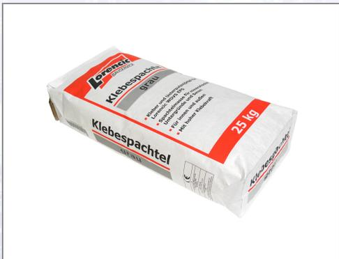
Mineralischer, pulverförmiger Klebemörtel, gut haftend, zum Kleben und Verspachteln von Wärmedämmverbundsystemen. Auch verwendbar für Putzübertragungen und Gewebespachtelungen. Auch als Spachtelmasse auf Beton geeignet. Verbrauch: ca. 4,5-5,5 kg/m<sup>2</sup> Kleben, ca. 4,0-5,0 kg/m<sup>2</sup> Spachteln (Unterputz 3 mm). Ergiebigkeit: ca. 2,4-2,9 m<sup>2</sup>/Sack.
