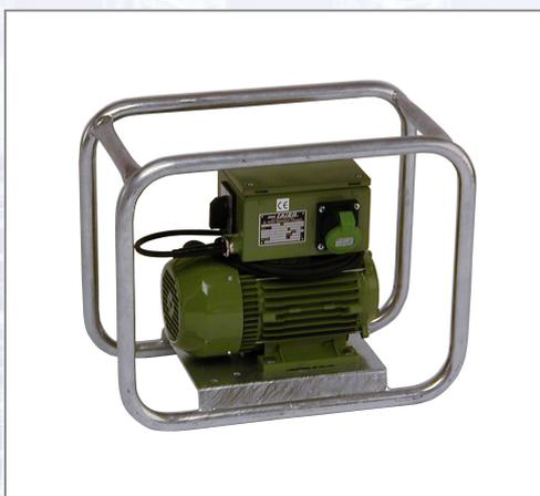
In Permanentmagnet-Ausführung. Umrichtung von 230 V auf 42 V. Speziell für die Anwendung von Rüttlern. Robuste Bauweise und geringe Reparaturanfälligkeit. Schutzart IP 44. Zum Anschluss von 2 Rüttlern bis LATI 57. Technische Daten: - Abgabe: 42 V / 27,5 A / 200 Hz, - Primärspannung: 400 V, - Leistungsaufnahme: 2,4 kVA / 10,5 A, - Gewicht: 27 kg.
