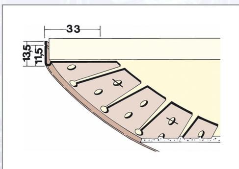
Einseitig angeschnittenes PVC-Abschlussprofil zur Herstellung von Schattenfugen im Deckenbereich bei gebogenen Wänden. Das Profil sollte zusätzlich mit geeigneten Klammern befestigt werden, um eine Rückstellung zu vermeiden.
