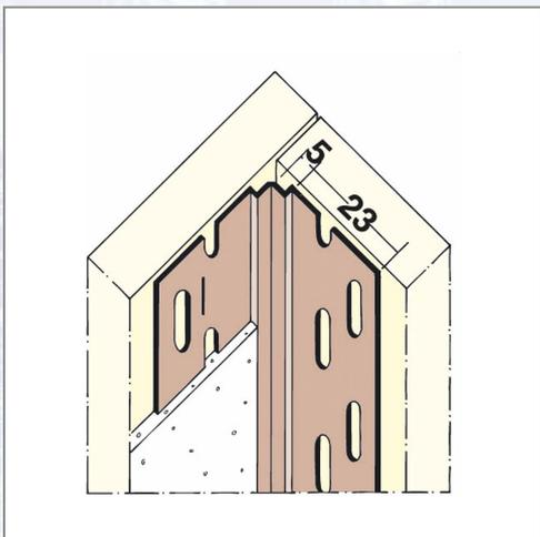
Inneneckprofil aus Hart-PVC, durch Knickfalte universell einsetzbar für Winkel von 70 Grad bis 135 Grad. Das Profil ist zusätzlich mit verzinkten Klammern zu befestigen.
