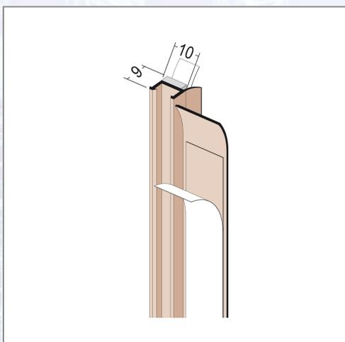
Selbstklebendes Laibungsanschlussprofil aus PVC mit Dichtlippe zur Herstellung einer technisch und optisch einwandfreien Detaillösung. Mindestverarbeitungstemperatur + 5 °C. Maximale Verarbeitungslänge 260 cm auf Grund möglicher Längenausdehnung. Bewegungsaufnahme nach ÖNORM B 6400 / ÖAP-VAR VII Klasse I C.
