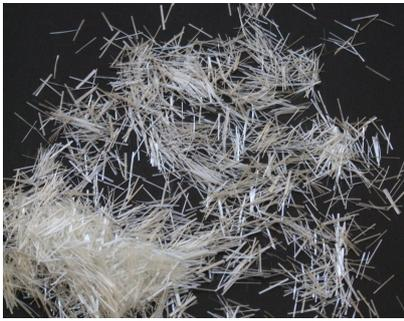
Vorteile: - homogene Verteilung und keine Bildung von Klumpen, - kein Herauskommen auf der Oberfläche, - Minimierung der Frühschwindrisse in Zement, - Übernahme von Spannungen während des Abbindeprozesses, - niedriger Preis als PP- und AR-Glasfasern dank hoher Verfügbarkeit am Markt, - Fasern rosten oder korrodieren nicht.
